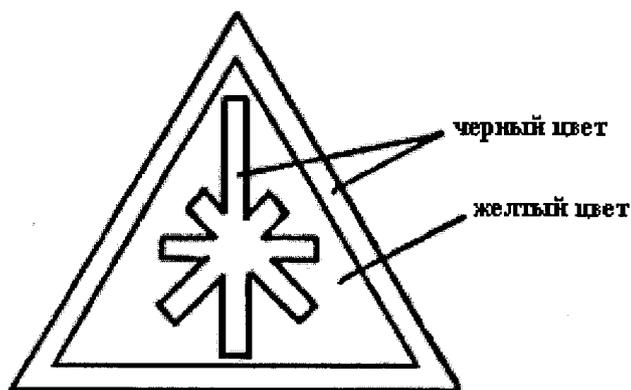
Рис. 8.2. Предупреждающий знак - знак лазерной опасности
